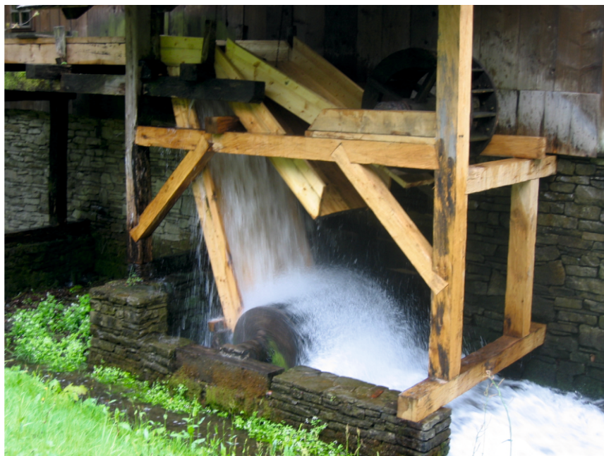
Vodní kolo roztáčené dopadající vodou
